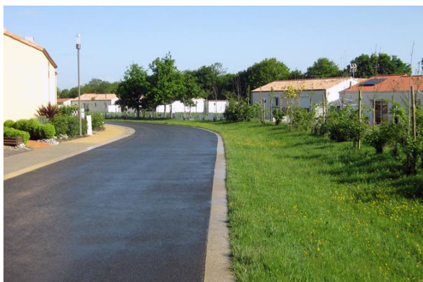
Exemple de voie structurante avec trottoir et noue
